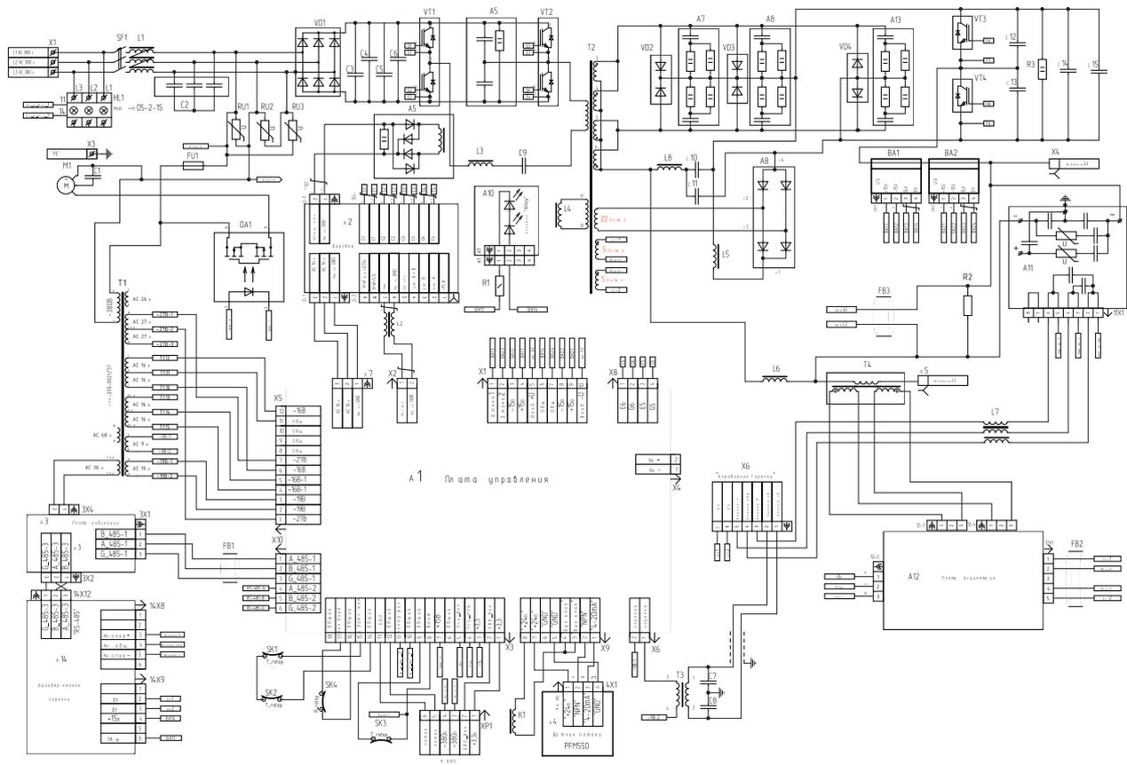
Рис. 3.1 Принципиальная электрическая блок-схема МС-315 Т2 AC/DC
