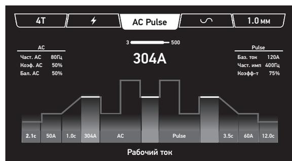
Пред продувка газом. Диапазон регулировки 0-10 сек
