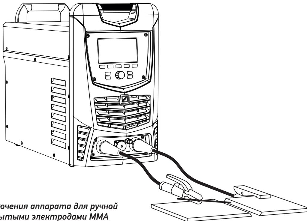
*Рис. 5.3 Схема подключения аппарата для ручной дуговой сварки покрытыми электродами ММА*
