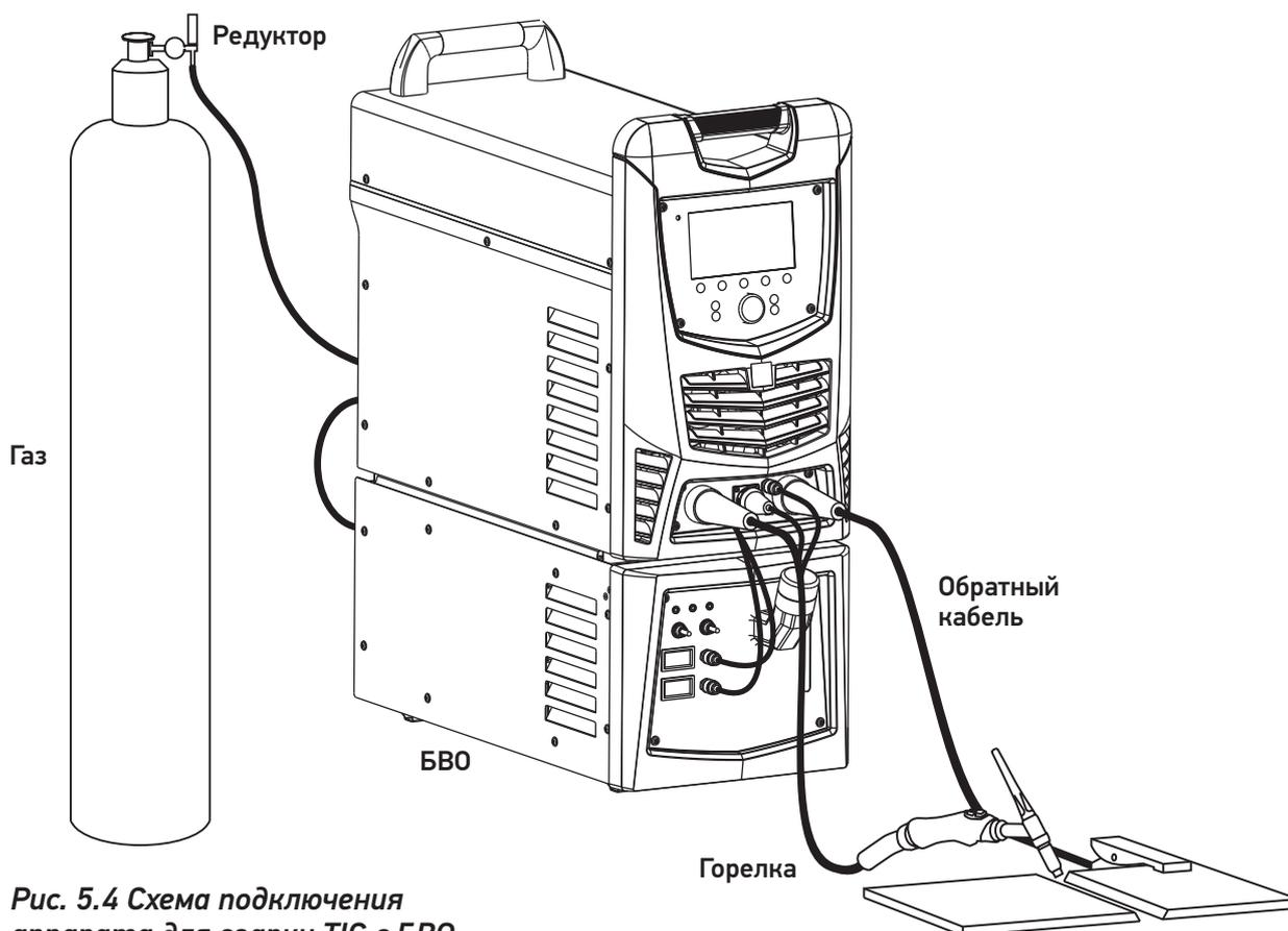
**Рис. 5.4** Схема подключения аппарата для сварки TIG с БВО
