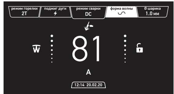
**Прямоугольная** – глубокое проплавление и стабильная сварочная дуга. Подходит для сварки сплавов алюминия (АМг)
