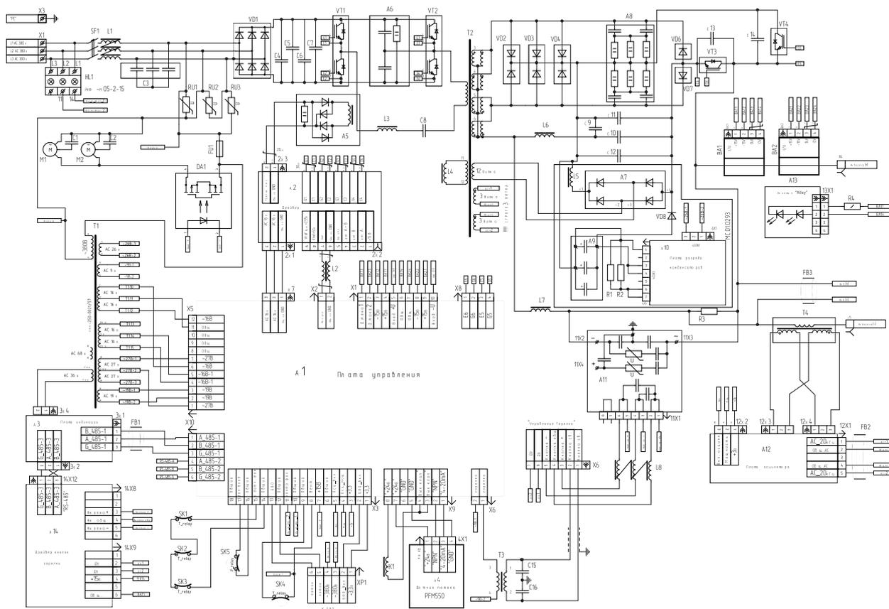
**Рис. 3.2** Принципиальная электрическая блок-схема MS-500 T2 AC/DC
