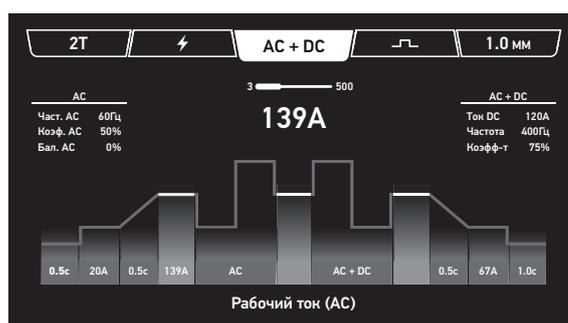
Включите питание на задней панели аппарата, дальнейшая работа производится на передней панели управления. Выберите режим AC + DC. Установите необходимые параметры режима, раздел 4 - п. 2, 3, 4.
