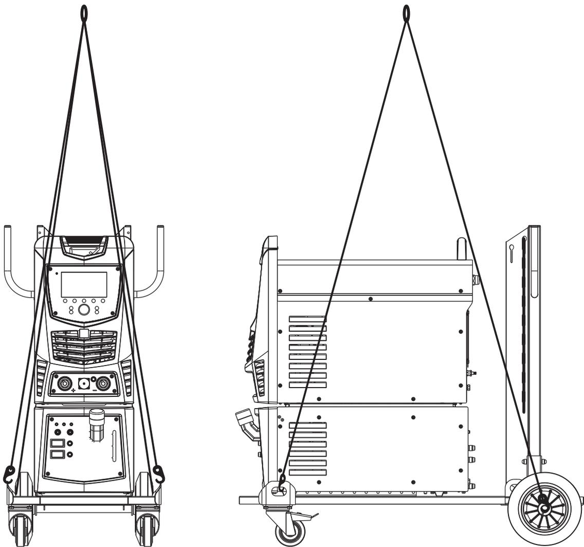
*Рис. 9.1* Схема строповки
