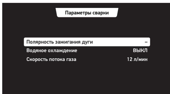
Полярность зажигания дуги: (+) / (-)
