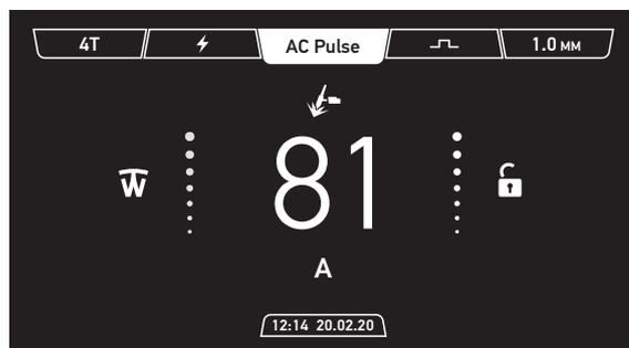
Для корректировки значений дополнительных параметров режима перейти к циклограмме процесса сварки AC Pulse, DC Pulse.
